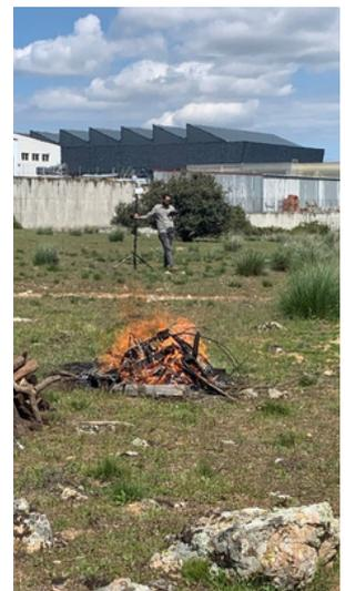
Pruebas de sensores en campo realizadas el 7 de mayo en Ávila. A la izquierda, vista general del área de ensayo, en el polígono industrial de Vicolozano, y del monitoreo ambiental durante varias quemas controladas (derecha), donde se evaluaron sensores de gases de los tipos SEC y MOX instalados en poste (centro), expuestos a concentraciones reales de gases y COV.
