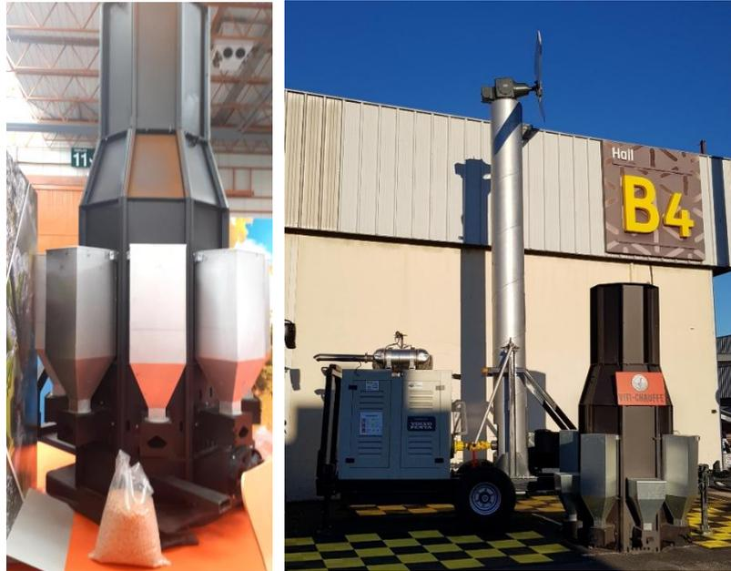
Figura 58.- Sistema de aquecimento anti-gelada (pellets) para funcionar em combinação com o ventilador.
