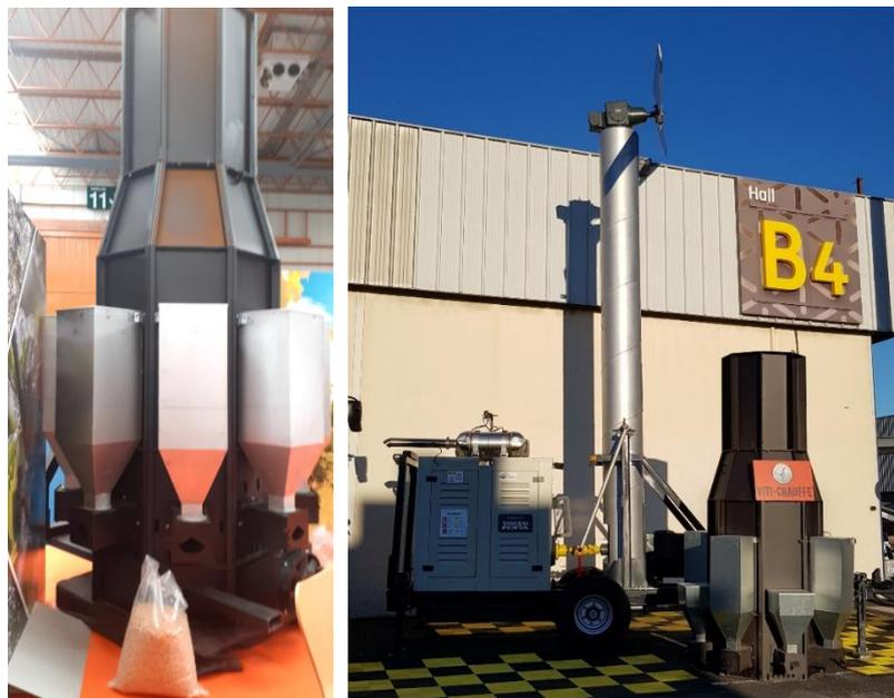
**Figura 58.-Sistema de calefactor antiheladas (pellets) para trabajar en combinación con ventilador.**
