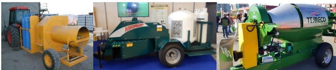
**Figura 57.- Diferentes modelos de calefactores móviles. Izquierda: Calefactor de propano. Centro: Sistema Frostbuster de propano. Derecha: Modelo Segués Terreco para restos vegetales.**
