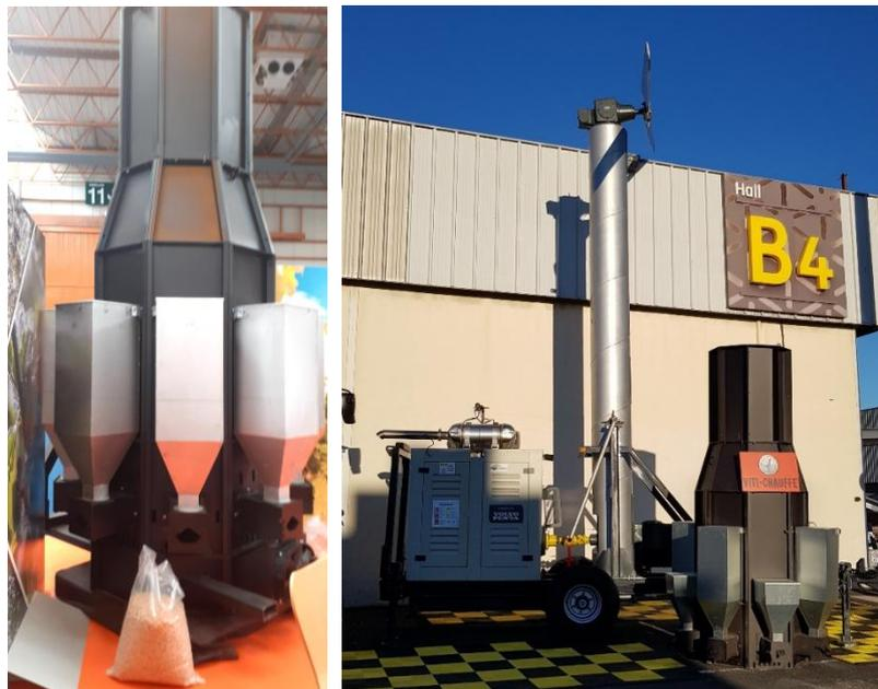
Figure 58 : Système de chauffage antigel (pellets) à combiner avec le ventilateur.
