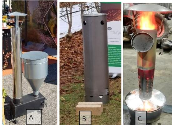
Figure 55.-Modèles de chaufferettes pour différents combustibles : modèle à granulés Viti-Chauffe (A), modèle à briquettes de bois Wiesel (B) et modèle au gazole (C).
