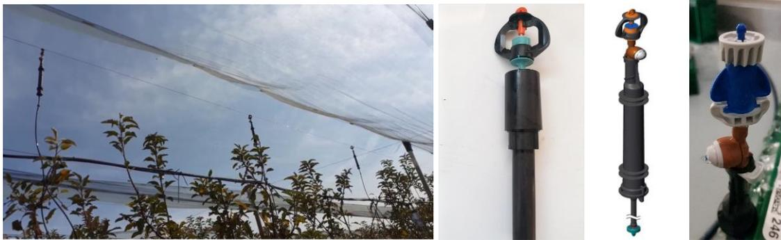
Figure 49 : Installation d'un système de micro-pulvérisation pulsée. A gauche. A droite, deux modèles de micro-asperseurs avec système de pulsation.
