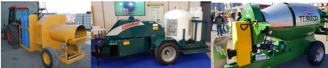
**Figure 57 : Différents modèles de chauffages mobiles. A gauche : Chauffage au propane. Au centre : système Frostbuster au propane. A droite : modèle Segué's Terreco pour les déchets végétaux.**
