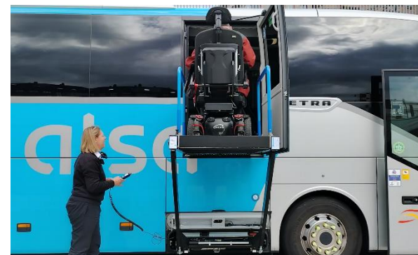
Elevador de autobús en uso por una persona en silla de ruedas.
