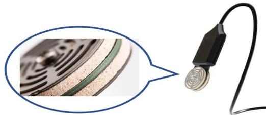
*Illustration 18 : Sonde de tension capacitive à matrice de sol*
