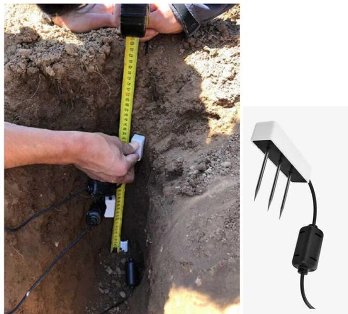
*Illustration 16 : Installation de sondes d'humidité à différentes profondeurs*
