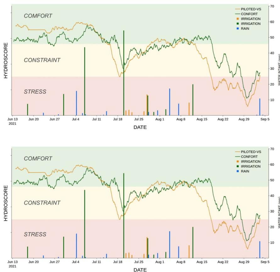
Figura 11: Ferramenta da empresa “Vegetal Signal”, Hydroscore, Uma aplicação para a monitorização em tempo real do estado hídrico das videiras.
