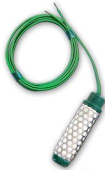
*Figura 19: Sonda Resistiva de tensão de matriz do solo*
