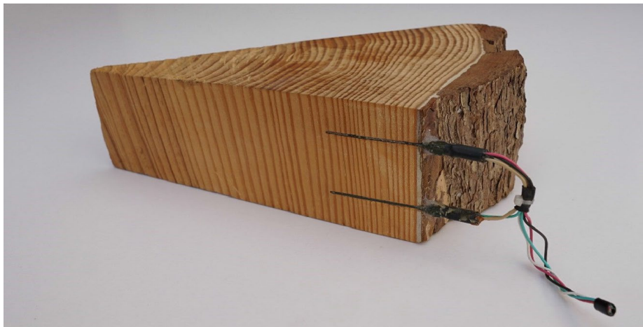
Ilustración 8: Sensores de flujo de savia. Fuente Fernando Casares Universidad de Córdoba
