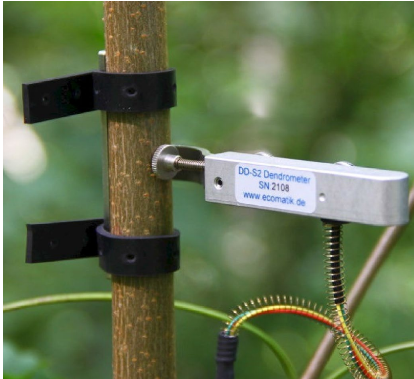
Ilustración 7: Dendrómetro. Fuente Fernando Casares Universidad de Córdoba
