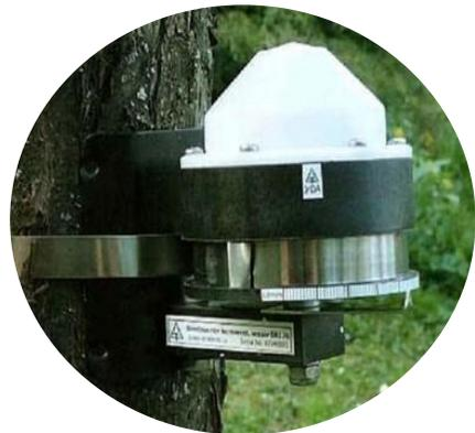
Dendrómetro de lámina
