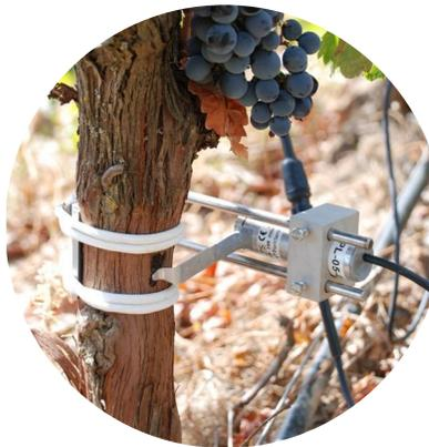
Dendrómetro de desplazamiento lineal
