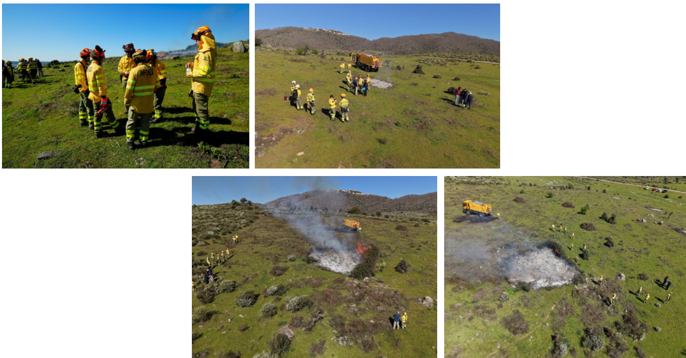
Proceso de ejecución de la quema experimental de Cytisus multiflorus , con seguimiento técnico y científico para validar sensores en condiciones reales.
