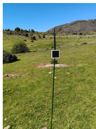
Red de sensores ambientales de bajo coste (meteorológicos, edáficos y de calidad del aire) conectados mediante LoRaWAN para monitorización en tiempo real.
