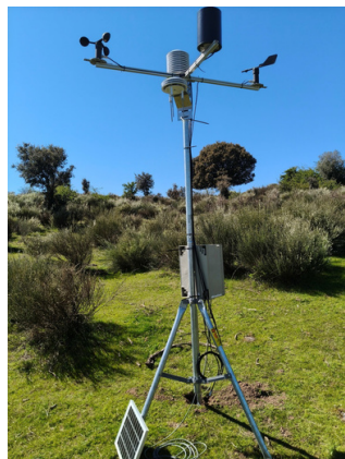
Red de sensores ambientales de bajo coste (meteorológicos, edáficos y de calidad del aire) conectados mediante LoRaWAN para monitorización en tiempo real.
