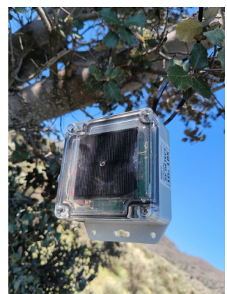
Red de sensores ambientales de bajo coste (meteorológicos, edáficos y de calidad del aire) conectados mediante LoRaWAN para monitorización en tiempo real.
