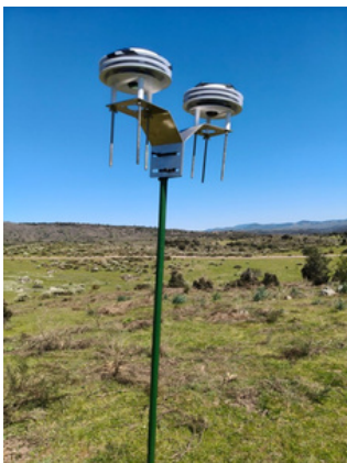
Red de sensores ambientales de bajo coste (meteorológicos, edáficos y de calidad del aire) conectados mediante LoRaWAN para monitorización en tiempo real.
