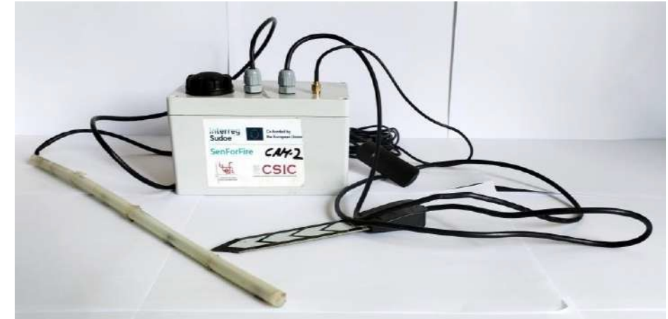
Módulos electrónicos / suelo (T, humedad, potencial hídrico)
