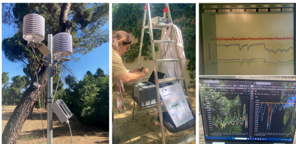
Módulos electrónicos con los microsensors del IMB-CNM (CSIC) instalados en INIA (CSIC) para monitorizar las quemas realizadas en el túnel de viento.
