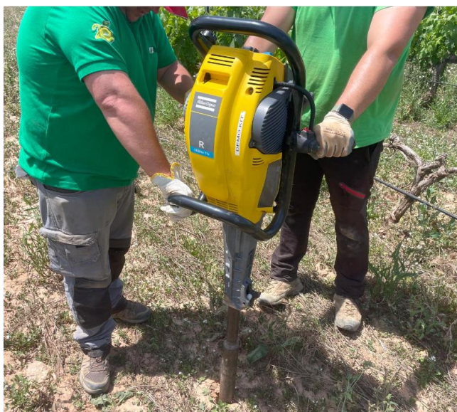
Figura 17. Obtención de muestras inalteradas mediante muestreador de ventana por ITAGRA, permitiendo la extracción de perfiles completos de sedimento para su análisis vertical en laboratorio.
