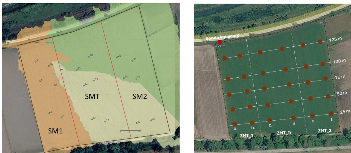
Figura 10. Piloto de IPC-Calcob en Coimbra (Portugal). Integración de la cartografía hidrológica (delimitación de subcuencas basada en red de drenaje y acumulación de flujo) y la variabilidad edáfica (mapa de conductividad eléctrica aparente del suelo, CEa) para la definición de la red de puntos de muestreo de suelo.
