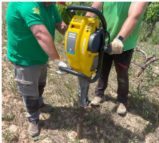
Figure 17. Prélèvement d'échantillons intacts à l'aide d'un échantillonneur à fenêtrage ITAGRA, permettant l'extraction de profils sédimentaires complets en vue d'une analyse verticale en laboratoire.
