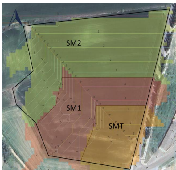
Figure 8. Projet pilote ITAGRA à Villamuriel de Cerrato (Palencia, Espagne). Intégration de la cartographie hydrologique (délimitation des sous-bassins basée sur le réseau de drainage et l'accumulation de débit) et de la variabilité édaphique (carte de la conductivité électrique apparente du sol, CEa) pour la définition du réseau de points d'échantillonnage du sol.
