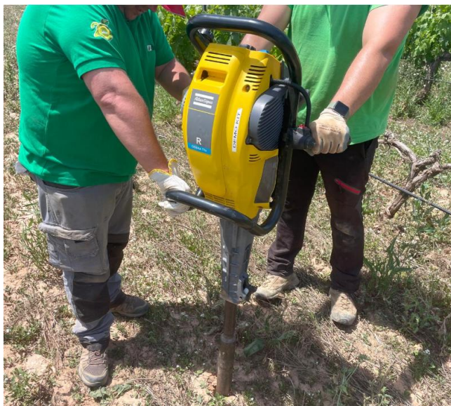
Figura 17. Obtenção de amostras inalteradas através do amostrador de janela da ITAGRA, permitindo a extração de perfis completos de sedimentos para análise vertical em laboratório.
