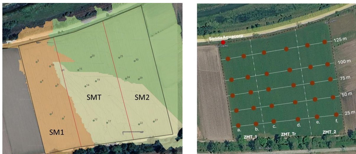
Figura 10. Projeto-piloto do IPC-Calcob em Coimbra (Portugal). Integração da cartografia hidrológica (delimitação de sub-bacias com base na rede de drenagem e acumulação de caudais) e da variabilidade edáfica (mapa da condutividade elétrica aparente do solo, CEa) para a definição da rede de pontos de amostragem do solo.
