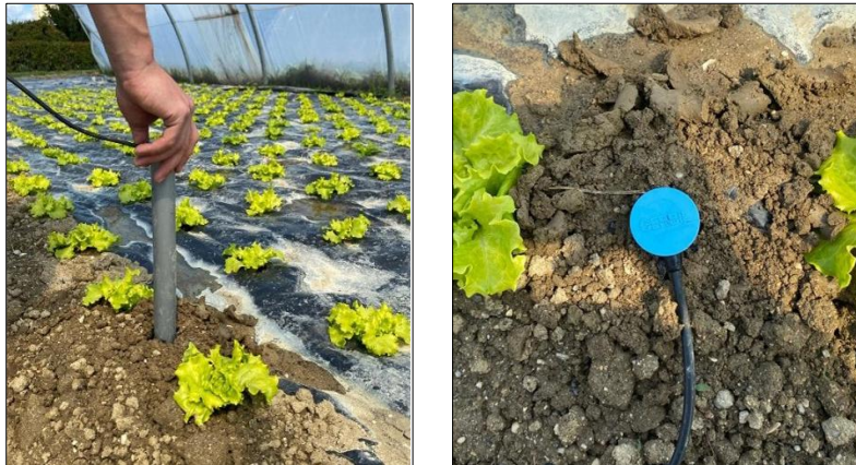
Figura 4: Imagen de un sensor tubular y su instalación.
