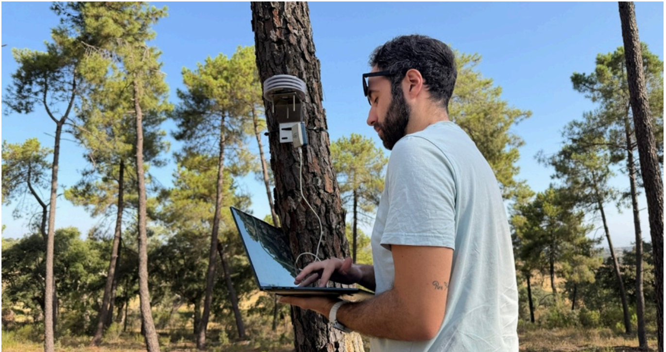
Ángel López (UEX) actualiza el firmware de un nodo sensor de SenForFire en las zonas piloto de Cáceres.
