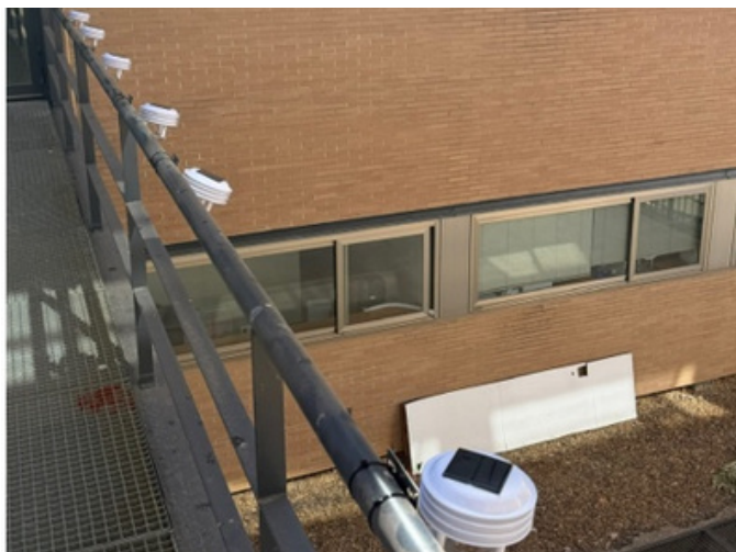
Nodos de sensores MOX instalados en la Escuela de Ingenierías Industriales para las pruebas de firmware .
