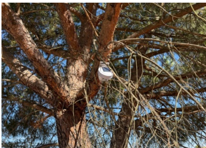
Nodos de sensores MOX, EC y PM y router LoRa desplegados junto al barrio de Las Vaguadas (Badajoz).
